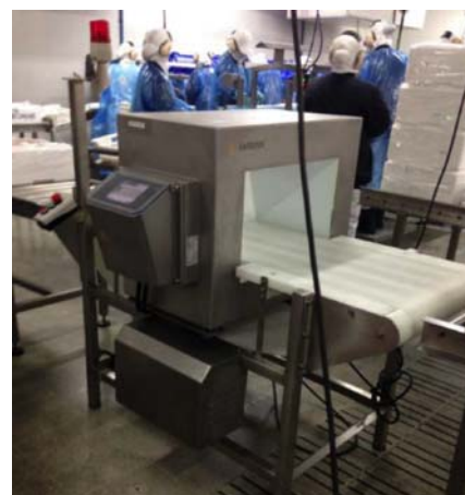
Detector de metales. Punto Crítico de Control para riesgos físicos.
